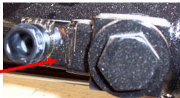
SQ 36 à SQ 39 fixé sur vérins essieux SQ36 up to SQ39 fixed on axles cylinders
