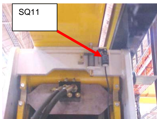
SQ11 : capteur flèche sur tourelle /boom sensor on turret
