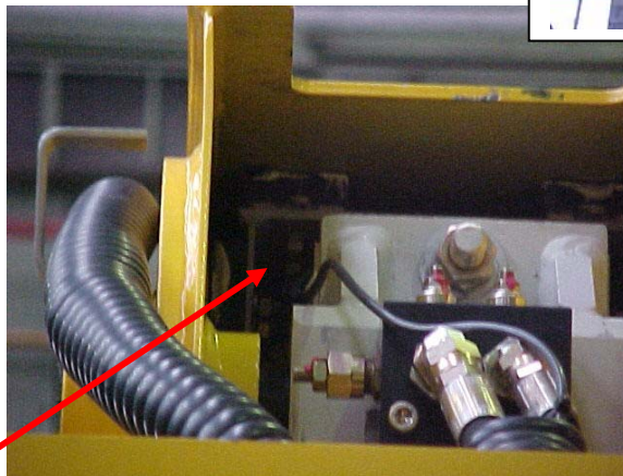
SQ12 capteur chaîne cassé / sensor chain breakdown
